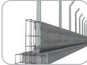
Perde Duvar İçerisinde Betonlama
