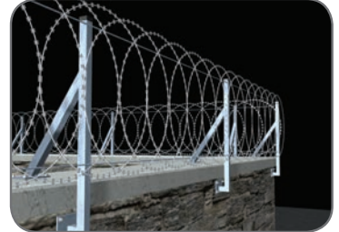
Dikmeli, Duvar Üzeri Düzlemsel
